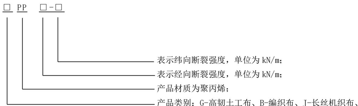
示例：高韧土工布聚丙烯土工管袋，经向断裂强度 120kN/m，纬向断裂强度 120kN/m，表示为：G PP 120-120。
